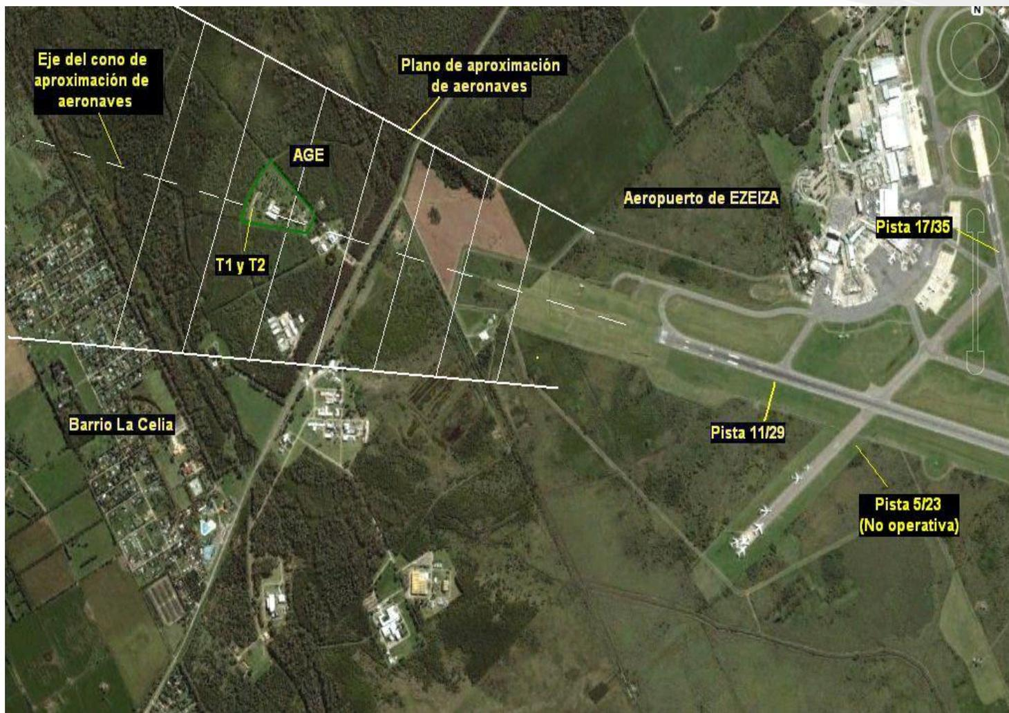
**El AGE y específicamente las trincheras objeto de la presente evaluación, se encuentran por debajo del eje del cono de aproximación de aeronaves de la pista 11/29, a una distancia de aproximadamente 3782 metros (entre la T2 y el centro de la pista)**
