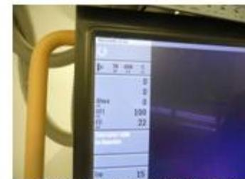
6 - Se puede observar en algunos equipos que la distancia de 100 cm entre el tubo y el detector está indicada en el monitor.
