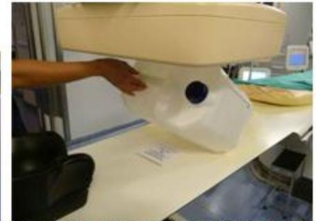
7 - Se coloca el bidón lleno de agua sobre el sobre que contiene los dosímetros, tratando de que quede todo perfectamente centrado con el tubo de RX y el detector.
