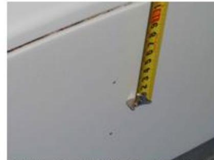
5 - Detalles: Ubicación del foco (anodo) del tubo de RX. 6 - Superficie de la mesa a 65 cm del tubo RX
